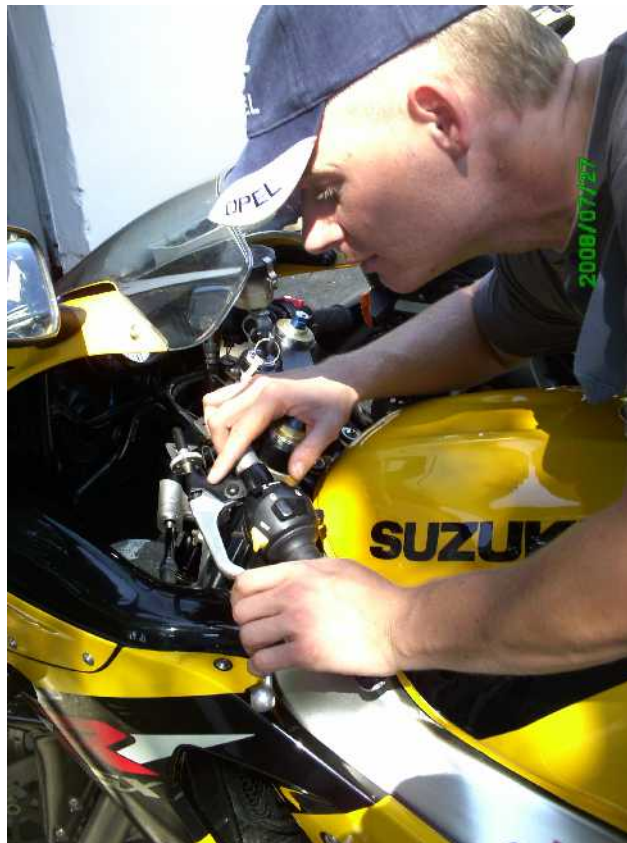
5. ábra A tengelykapcsoló kar holtjátékának ellenőrzése
